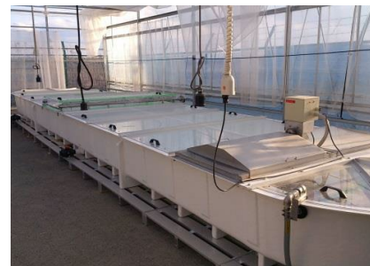
〔南蒲生浄化センター内の実験設備と藻類を培養している様子〕
