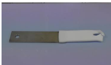
引張強度実験で PTFE 素材が切れた状態。接合部分には影響がない。
